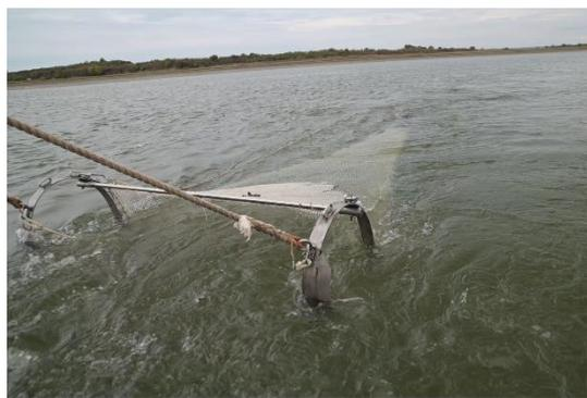
La réserve naturelle et la RNCFS se sont équipées d'un chalut à perche classique de 3 m d'ouverture, conforme aux indications fournies par Lepage, M., Girardin, M. & Bouju, V. 2008. Inventaire poisson dans les eaux de transition, procédure : protocole d'échantillonnage pour les districts de la façade Atlantique et Manche. irstea. 2008, pp.30.
